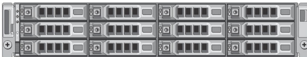
그림 2. DR Series 시스템 확장 선반(MD1200) 드라이브 슬롯 위치
